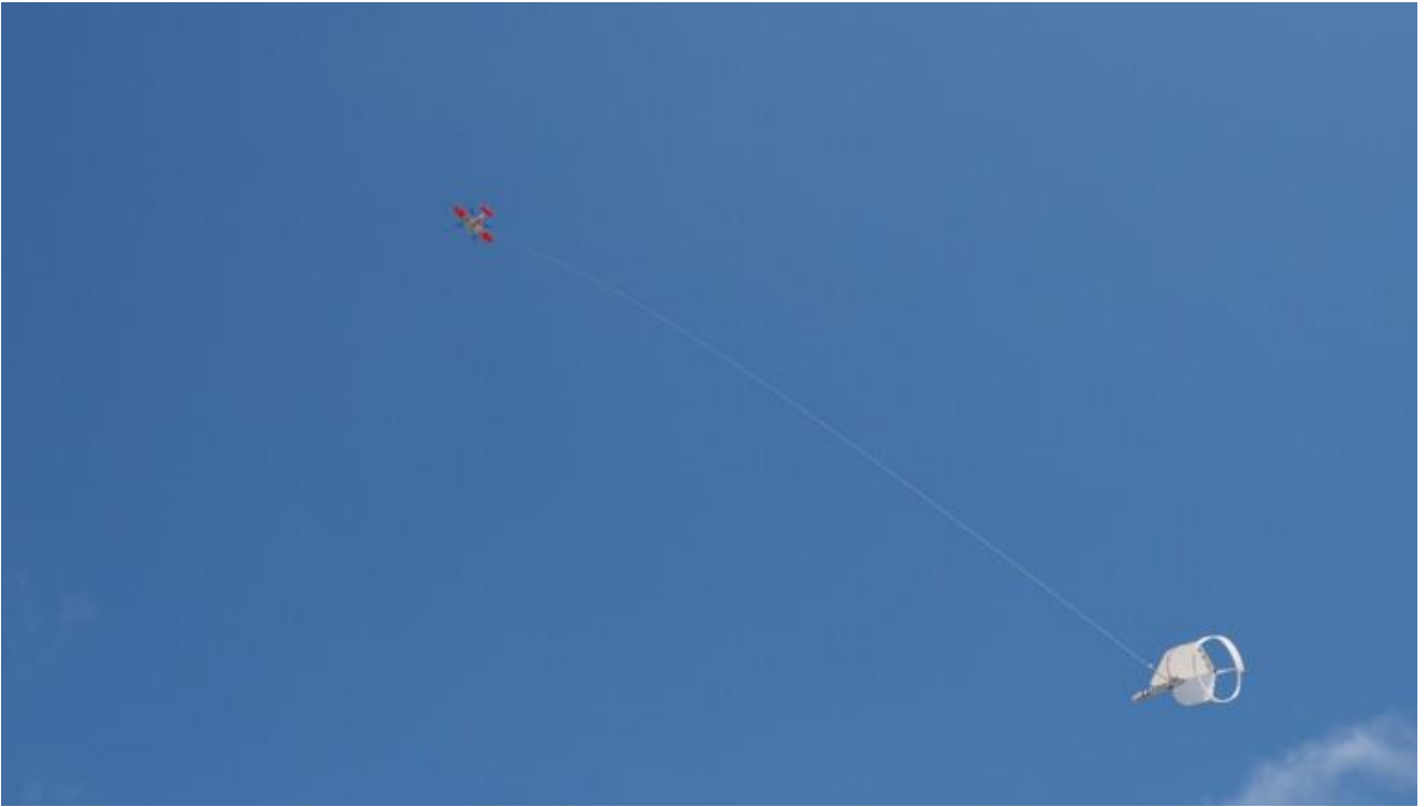
Testilennolla droni vetää 30 metriä pitkän vetonarun päässä mittalaitetta. Kuva: Radai Oy
